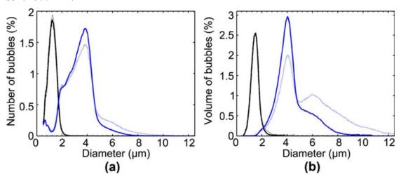
该图描述微泡数量百分(a)比和体积百分比(b)。不同微泡呈现的峰在大约 1μm – 2μm(黑色)和 4μm – 5μm(蓝色)是可见的。声波降解后,则呈现成微型气泡 (虚线)。说明 4μm-5μm 的微泡更容易降解。
