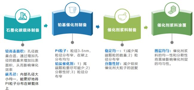
图3 PEMFC催化剂生产工艺流程图及制备关键点
