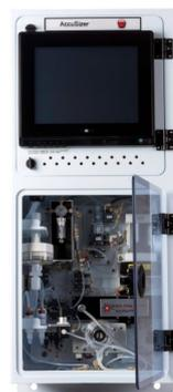
AccuSizer Mini FX (如左图)被设计用于更小的粒径和更高的浓度的检测。AccuSizer FX传感器使用聚焦光束来减少被检查的总体积，从而提高了传感器的浓度上限，并通常允许不稀释的情况下进行测量。FX传感器可以测量0.65-20微米的颗粒浓度比标准
