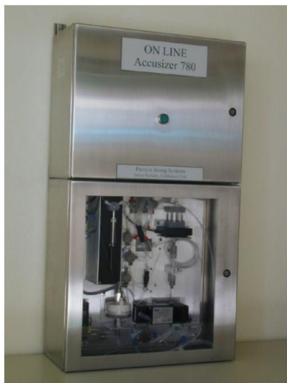
图 4: 用于自动监控浓缩 CMP 浆料的 AccuSizer™ 780 / ONLINE 光学粒度仪。
